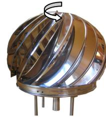
2) Entfernen Sie nun die Rotorkugel durch einfaches Herausziehen. Das Loch an dem die Rotorkugel an der Welle entlangläuft ist sehr eng, also ziehen Sie bitte mit etwas Geduld und Vorsicht die Kugel von der Welle ab.
